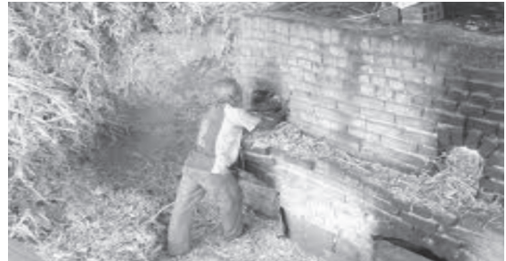
Fig. 4. Fotografía de la hornilla tradicional, muestra la tarea de suministro de bagazo hacia la hornilla del trapiche.
